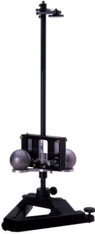
■ الشكل 6-7 تستعمل موازين كافندش الحديثة لقياس قوى الجذب بين جسمين.
