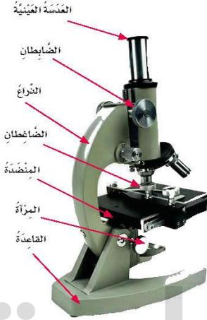
المجهر: أداة تُستخدَم مجموعة عدسات لتكبير الأشياء أو صورها لتبدو أكبر حجماً. ويكبر المجهر الأشياء مئات أو آلاف المرات. أنظر إلى الشكل المجاور وتعرف أجزاء المجهر المختلفة.
