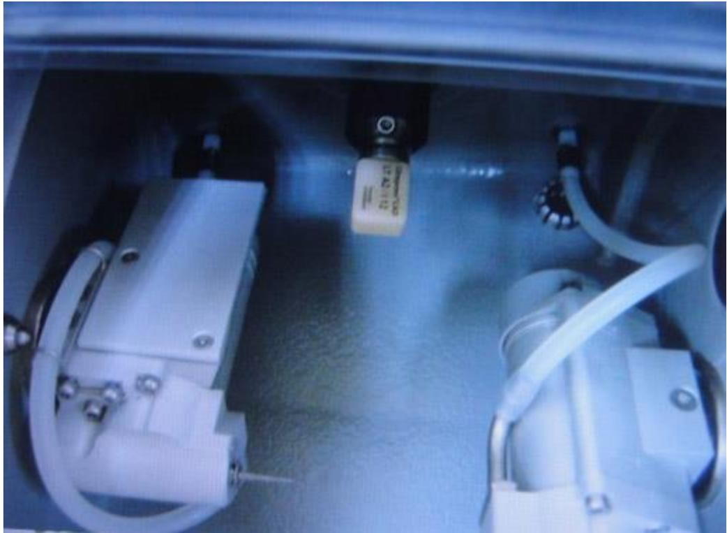
وضع المكعبات ضمن جهاز خاص لنحت هذه المكعبات وفق التصميم.
