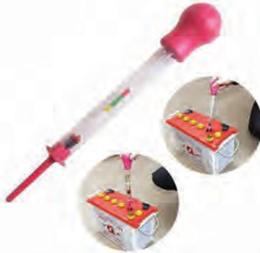
الشكل (٢-٩): الهيدروميتر جهاز قياس كثافة المحلول.
