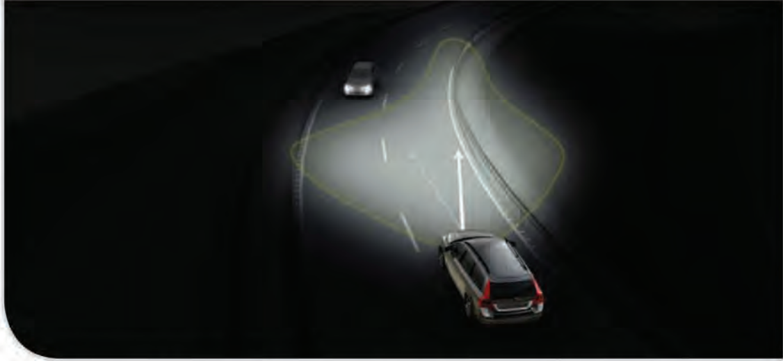
الشكل (٣-٥٣): نظام التحكم بالإضاءة عند مقابلة مركبة أخرى على الطريق.
