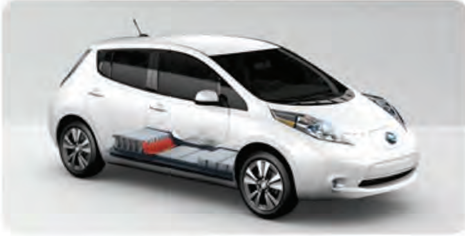
الشكل (٢-٢): وحدة المراكم في المركبة الكهربائية.
