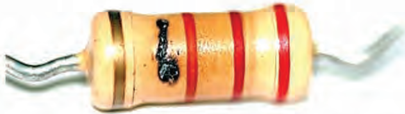
الشكل (١-٢٠): تلف المقاومة الكربونية.
