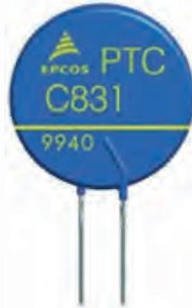
الشكل (٢٤-١): المقاومة ذات المعامل الحراري الموجب (PTC).
