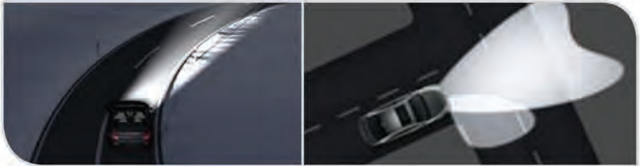
الشكل (٣-٥٢): نظام التحكم عند المفترقات الطرق.
