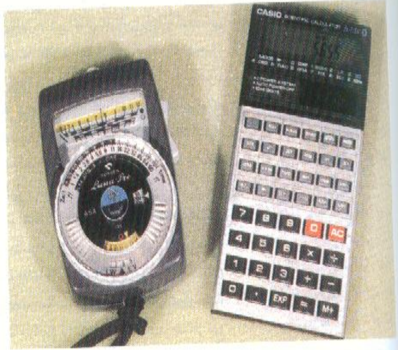
يعتبر مقياس التعرض للضوء والآلة الحاسبة ، أمثلة لأجهزة يعتمد عملها على الأثر الكهروضوئي .
