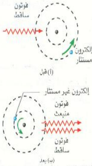
شكل 19-27: ينتج الانبعاث المستحث موجات مترابطة
