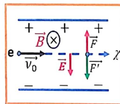
$$F_{\text{لورنز}} - F_{\text{كهربائى}} = 0$$
