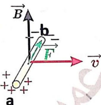
عند تحريك الساق بسرعة ثابتة  $\bar{v}$  ضمن حقل مغناطيسي منتظم  $\bar{B}$  بحيث:  $\bar{v} \perp \bar{B}$  فإن الإلكترونات الحرة في الساق ومع خضوعها لهذا الحقل تتأثر بقوة لورنزي:
