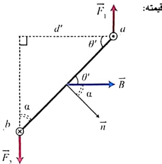
عند إمارار التيار الكهربائي في إطار المقياس، فإن الحقل المغناطيسي يؤثر في الإطار بمزدوجة كهرطيسية تعطى بالعلاقة:  $\bar{\Gamma}_\Delta = N I s B \sin \alpha$  (مزدوجة كهرطيسية)
