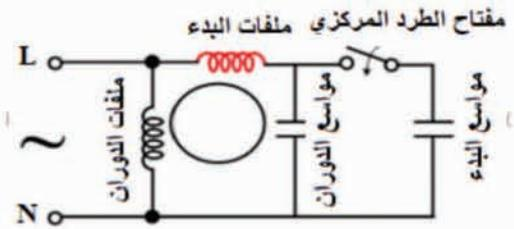
الشكل (٣-٣٣/أ): الدارة الكهربائية للمحرك ذي المواسعين.
