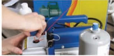
٤ تأكد من وجود زيت كافٍ داخل مضخة التفريغ قبل تشغيلها، إذا نقص الزيت، فأضف كمية مناسبة من الزيت الخاص بمضخة التفريغ؛ بحيث يجب أن يكون مستوى الزيت أعلى من علامة MIN، وأقل من علامة MAX الظاهرة على زجاجة رؤية زيت مضخة التفريغ الميينة في الشكل المجاور.
