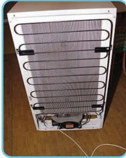
الشكل (٤-١١): مكثف مبرّد بالهواء بالحمل الطبيعي
