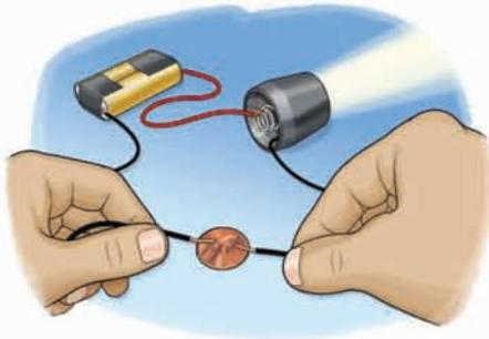
المواد الموصلة: هي المواد التي تسمح بمرور التيار الكهربائي عبرها؛ لأن هذه المواد تحتوي عددًا كبيرًا من الإلكترونات الحرة، ومن أهم المواد الموصلة للتيار الكهربائي المعادن؛ لأن المعادن تحتوي عددًا هائلًا من الإلكترونات الحرة القابلة للحركة تحت تأثير قوة خارجية كمصدر جهد كهربائي،
