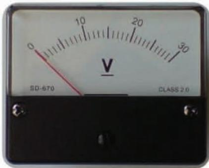
الشكل (٣-٢): جهاز قياس الفولتية.
