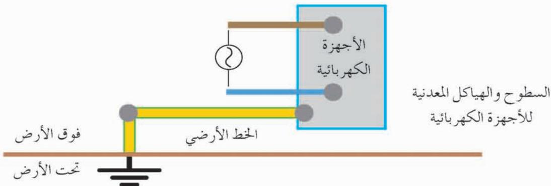
الشكل (٣-١٤): تأريض الدارات الكهربائية.
