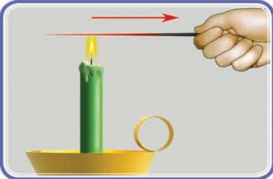
وهذا يدل على أن الحرارة تنتقل من طرف القضيب القريب من اللهب عبر القضيب الفولاذي إلى الطرف الآخر للقضيب الفولاذي، لذا؛ تسمى هذه العملية انتقال الحرارة بالتوصيل، فهل تتوقع أن الحرارة ستنتقل من القضيب الفولاذي إلى اليد التي تمسك به بالتوصيل أيضًا؟
