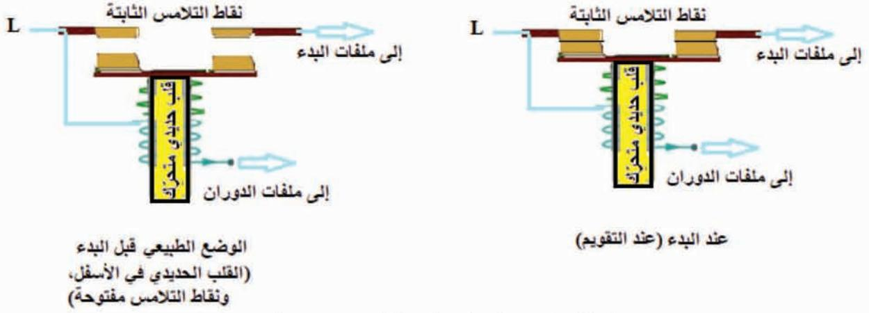
الشكل (٣-٣٨): المرحلات الكهربائية نوع التيار.
