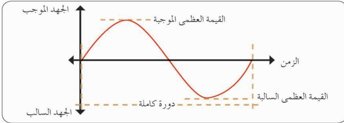
الشكل (٣-٤): منحنى التيار المتردد (شكل الموجة الجيبية).
