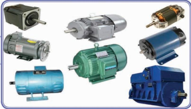
لعلك لاحظت أن بعض هذه المحركات يعمل بجهد كهربائي ٢٢٠ فولتًا، وهو أحادي الطور (واحد فاز)، لذا؛ فهو مناسب للتشغيل بكهرباء البيت، لكن البعض الآخر يحتاج إلى كهرباء (٣) فاز، وهذا لا يمكن تشغيله في البيت، لماذا؟ ستعرف عبر فقرة (اقرأ وتعلم) إجابة هذه الأسئلة والاستفسارات.
