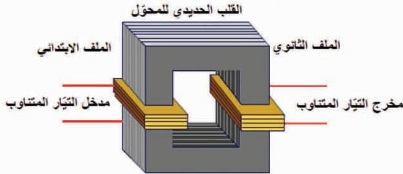
الشكل (٣-٣٦): مكونات المحول الكهربائي.
