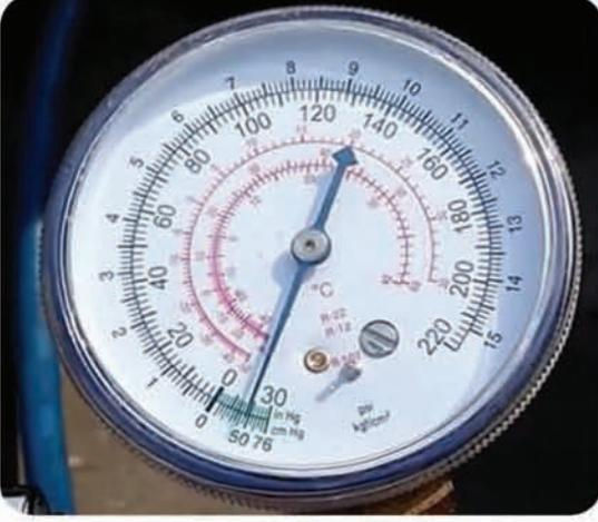
٧ صل مضخة التفريغ بالمصدر الكهربائي، ثم شغلها وراقب خروج الهواء من فتحة التفريغ، وراقب مؤشر مقياس الضغط المنخفض، ثم أغلق صمام مقياس الضغط، ثم افصل مصدر الكهرباء عن مضخة التفريغ، إذ يجب أن تثبت القراءة لمدة نصف ساعة تقريباً، إذا ارتفع المؤشر، فإن هذا يدل على وجود تسريب يجب معالجته ثم إعادة التفريغ.
