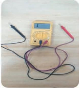
٤ تأكد من صلاحية جهاز القياس الكهربائي (الملمتيمتر)، ثم اضبط مفتاح الاختيار على تدريج المقاومة عند قيمة تزيد عن القيمة المتوقعة للمحرك ذي القطب المظلل، لتكن أعلى قيمة مقاومة في تدريج جهاز القياس، ثم ضع طرفي أسلاك الفحص في المكانين المخصصين في جهاز الفحص.
