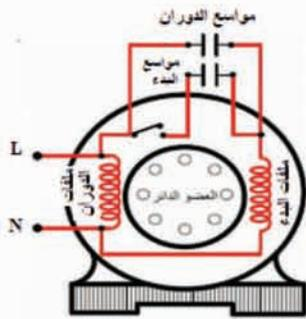
الشكل (٣-٣٣/ب): طريقة توصيل للمحرك ذي المواسعين.
