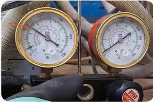
٦ أغلق صمام الأسطوانة، وافتح الصمام الأزرق لجهاز القياس، وافتح خط خدمة المكيف لتقيس ضغط وسيط التبريد للمكيف، وراقب ارتفاع المؤشر حتى يثبت، ثم سجّل قيمة الضغط التي قاسها الجهاز، بماذا تفسّر النتائج التي حصلت عليها؟ ناقش مدربك في ملاحظاتك.
