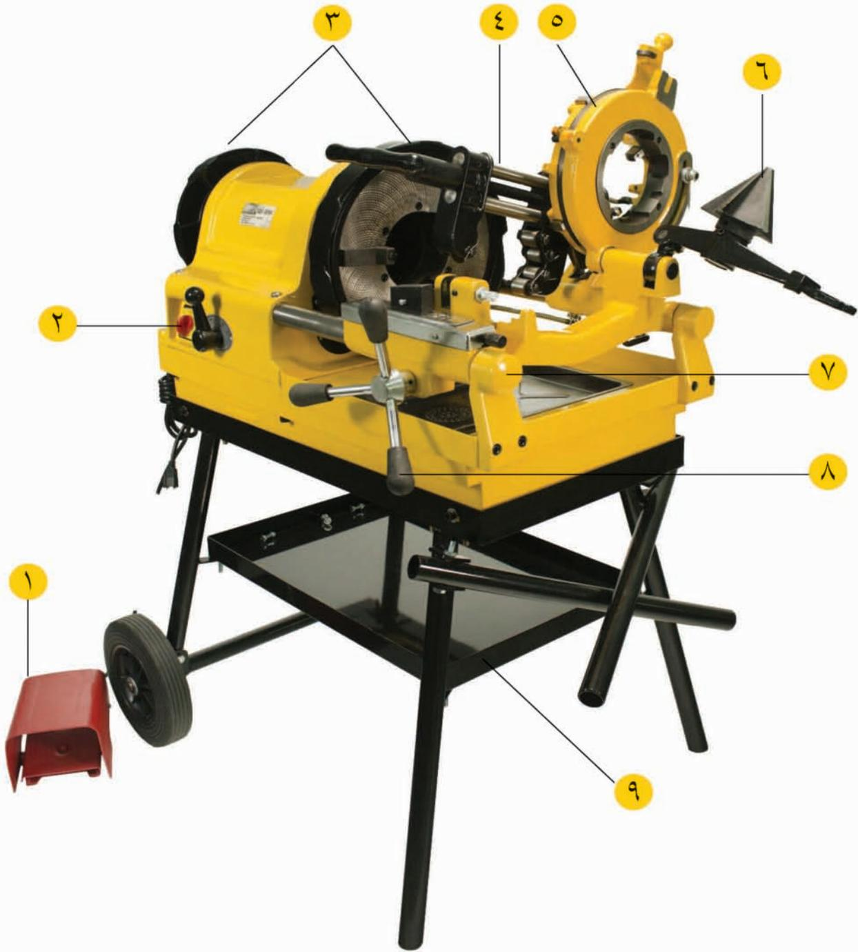
الشكل (١١-٢) : آلة التسنين الكهربائية الشاملة.
