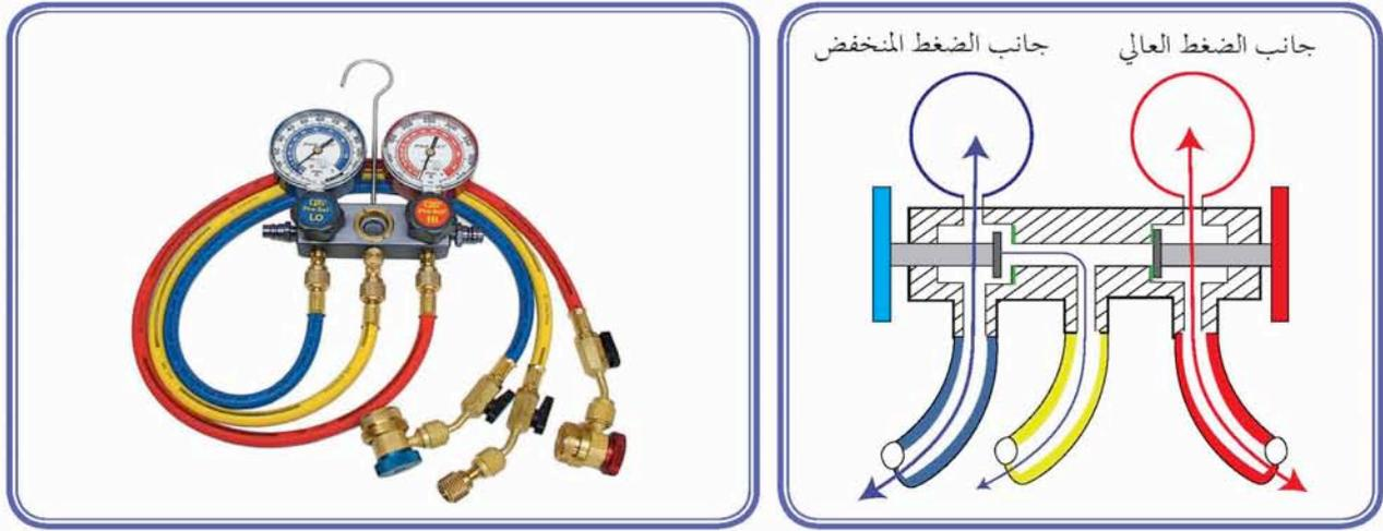
الشكل (١-١٠): مقياس بوردين لقياس ضغط وسيط التبريد (ساعات الشحن).
