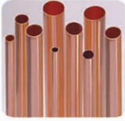
أ- أنابيب النحاس المقسّاة (Hard Drawn Copper Tubing): صلبة يصعب ثنيها، تستعمل غالبًا في شبكات التبريد ذات المسافات والقدرات الكبيرة، ويكون طول الأنبوب الواحد ٦ أمتار.
