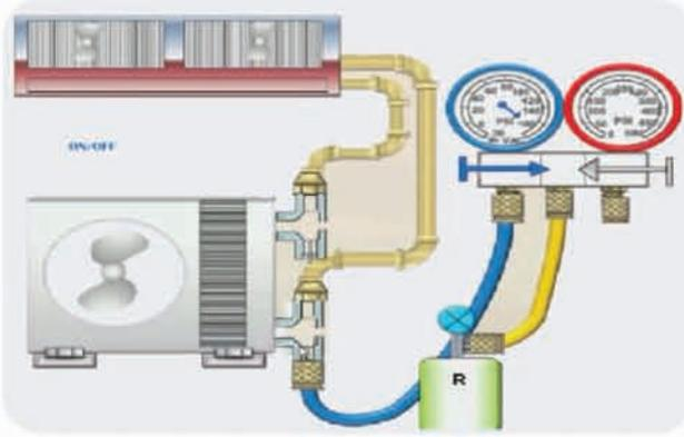
إذا كنت تتوقع أن الضغط المراد قياسه قيمته قريبة من (٣٠٠ psi)، عليك أن تختار جهاز قياس تدريجه يزيد على (٣٠٠ psi)، لاحظ الشكلين المجاورين، تجد أن المقياس الذي قيمة ضغطه القصوى التي يمكنه قياسها هي (٥٠٠ psi)؛ لذلك فهو مناسب لقياس ضغط قيمته (٣٠٠ psi)، وكذلك هو مناسب لقياس أي ضغط أقل من (٥٠٠ psi)، أما المقياس الذي قيمته القصوى (٢٥٠ psi)، فهو غير مناسب لقياس ضغط تصل قيمته إلى (٣٠٠ psi).
