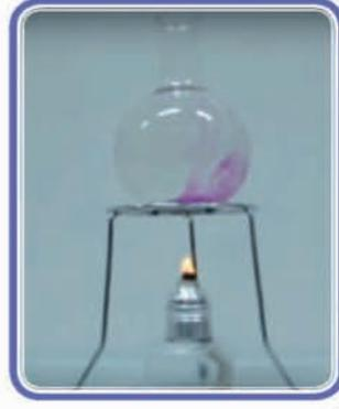
لعلك لاحظت أن طبقة الماء الكلي (التي هي من انقلها لجزءها من الماء) تسخن وترتفع إلى الأعلى حاملة معها الحرارة، ويحل محلها أسفل الوعاء طبقة باردة جديدة حتى تسخن وترتفع إلى الأعلى، وهكذا تستمر عملية انتقال الحرارة بالحمل بين طبقات الماء على صورة تيارات من الماء الصاعد إلى الأعلى والنازل إلى أسفل، لذا؛ تسمى عملية نقل الحرارة في السوائل والغازات انتقال الحرارة بالحمل.
