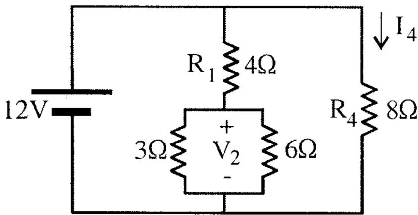
مثال 4.4: للدائرة بالشكل أوجد  $I_4$  و  $V_2$
