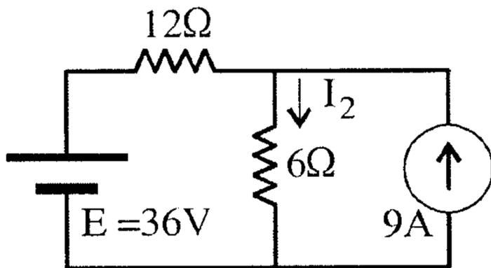
مثال 3.6 باستخدام نظرية التراكيب أوجد التيار المار خلال المقاومة (6Ω).
