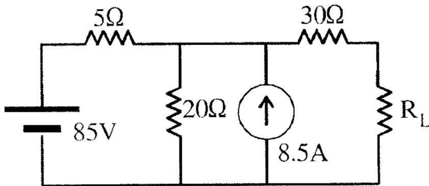
(5) باستخدام مكافئ ثيفنين أوجد قيمة  $R_L$  التي تسحب أقصى قدرة ممكنة ثم احسب أقصى قدرة منقولة لها.
