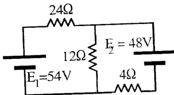
مثال 2.6 باستخدام نظرية التراكيب أوجد التيار المار خلال المقاومة  $(4\Omega)$ .
