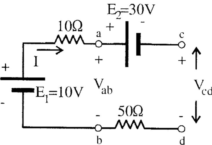
مثال 23.3 من الدائرة بالشكل أوجد  $V_{ab}$  و  $V_{cd}$
