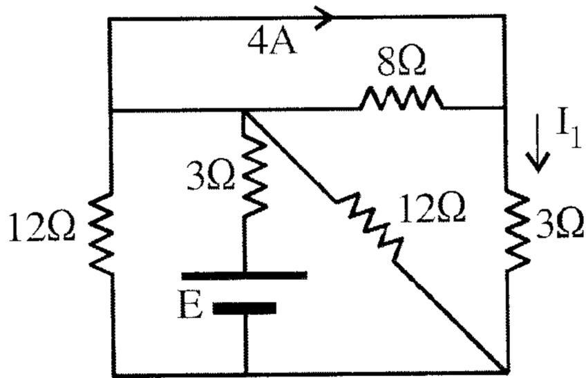
المسألة 22.4 أوجد قيمة جهد المصدر (E) وكذلك التيار  $I_1$  المار في المقاومة  $(3\Omega)$ .
