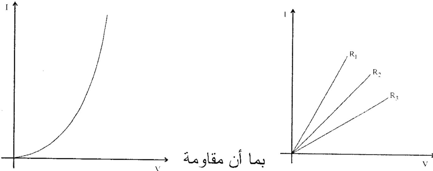
الموصل تعتمد على درجة الحرارة ارتفاعاً وانخفاضاً فإن العلاقة بين شدة التيار الكهربائي (I) وفرق الجهد (V) تكون غير خطية، والحقيقة أن التغير في درجة الحرارة يسبب تغيراً في المقاومة النوعية وفق العلاقة التالية:
