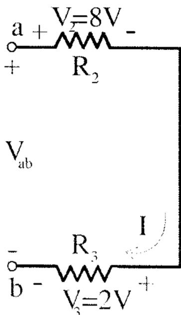
$$V_{ab} - V_2 - V_3 = 0$$
