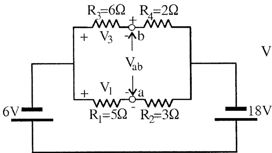
1- أوجد الجهود  $V_{ab}, V_3, V_1$
