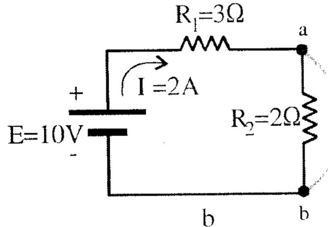
الشكل ( a ) يمثل دائرة توالٍ عادية يمر التيار عبر المقاومتين (  $R_1, R_2$  ) ، وفي الشكل ( b ) يتغير مسار التيار عند توصيل طرفي المقاومة (  $R_2$  ) بسلك من النقطة ( a ) إلى النقطة ( b ) . ماذا يحدث للتيار في هذه الحالة؟ التيار لا يمر عبر المقاومة (  $R_2$  ) وتسمى (Short Circuit) وتيارها (  $I_{Rsc}$  ) تيار (Short Circuit) يكون عالي القيمة (أي التيار المار عبر السلك a,b) ، أما مقاومة (Short circuit) فتساوى (  $R_{sc} = 0$  ) .
