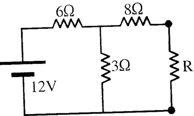
مثال 20.6 أوجد قيمة المقاومة  $R$  التي تحقق انتقال أقصى قدرة ثم احسب القدرة الناتجة.
