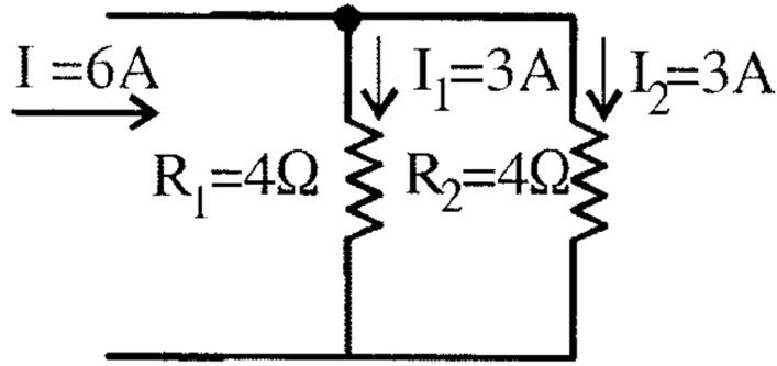
2- أما التيار المار في مقاومتين مختلفتين فيتجزأ بحيث يكون للمقاومة الأصغر تيار
