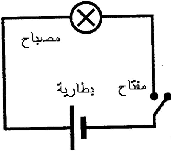
ومفتاح موصلة على التوالي. عند إغلاق المفتاح يمر التيار ويضيء المصباح، أما عند فتح المفتاح فيتم قطع التيار وبالتالي ينطفئ المصباح.
