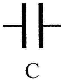
وتعتمد الطاقة الكهربائية المخزنة في المكثف على شكله الهندسي، وعلى فرق الجهد الكهربائي بين لوحيه، وكذلك على نوع العازل الذي يفصل بين اللوحين.
