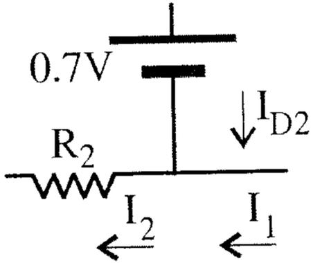
أخيراً وباستخدام قانون التيار لكرشوف يمكن إيجاد التيار  $I_{D2}$
