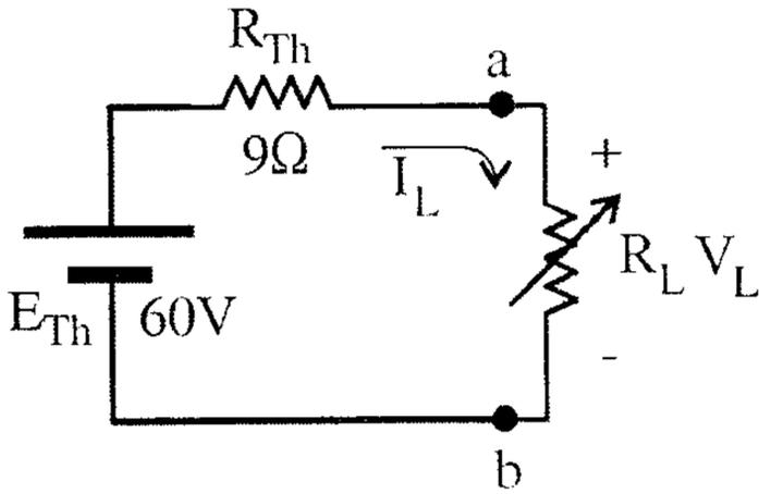
**مثال 18.6** احسب القدرة المستهلكة في مقاومة الحمل ( $R_L$ ) وكذلك الجهد ( $V_L$ ) والتيار ( $I_L$ ).
