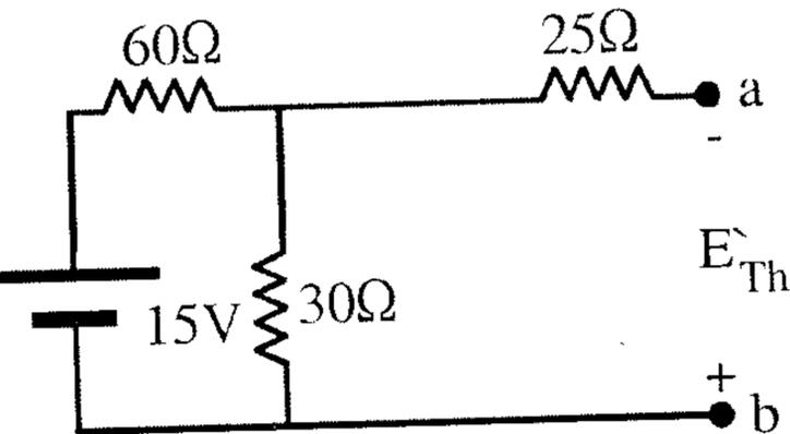
المقاومة  $25\Omega$  تلغى (Open Circuit)
