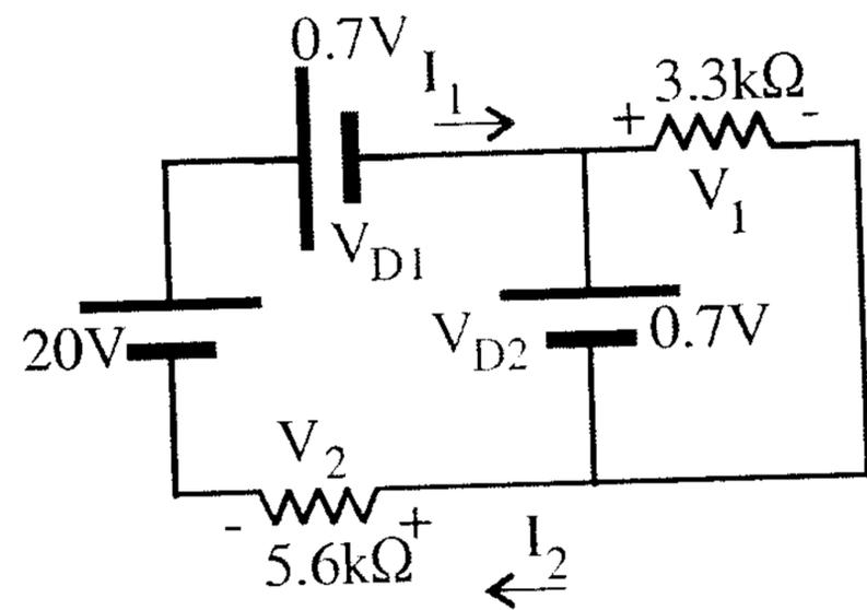
بما أن  $V_{D2} = V_1$  بالتوازي وتساوي  $0.7V$
