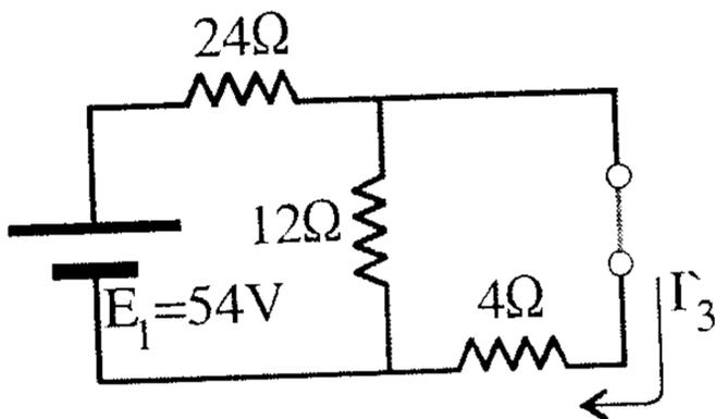
وباستخدام قانون مجزئ التيار نحصل على التيار المار في المقاومة (4Ω)
