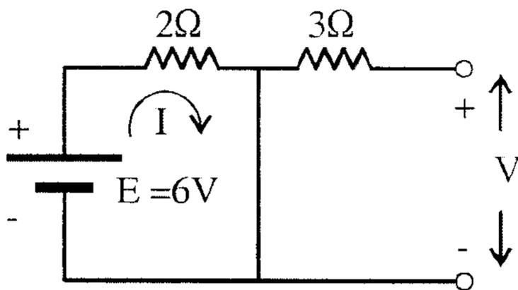
$$V_{3\Omega} = I (3\Omega) = (3\Omega) (0) = 0V$$
