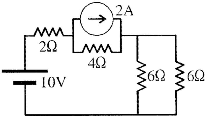
(4) أوجد قيمة التيار المار في المقاومة (2Ω) .
