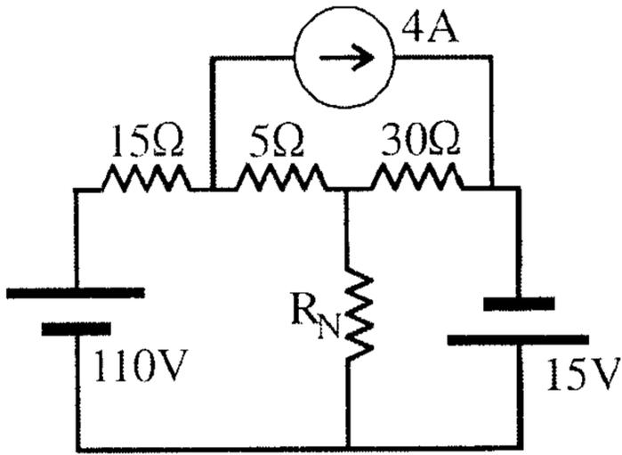
(2) باستخدام مكافئ ثيفنين أوجد قيمة  $R_L$  التي تسحب أقصى قدرة ممكنة ثم احسب أقصى قدرة منقولة لها.
