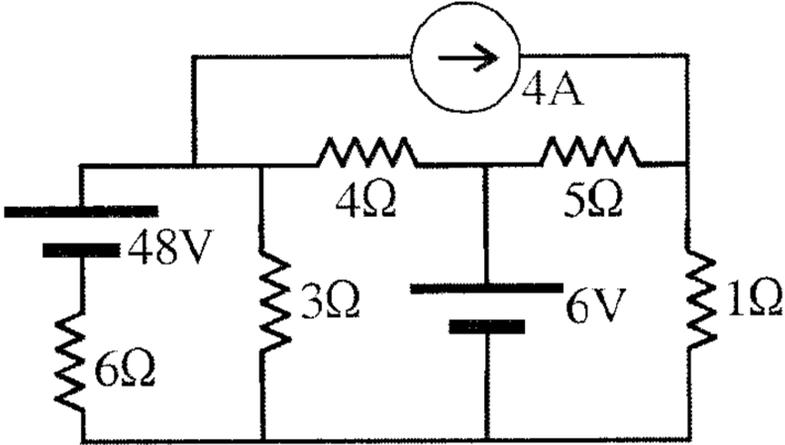
(2) أوجد قيمة التيار المار في المقاومة (5Ω) .
