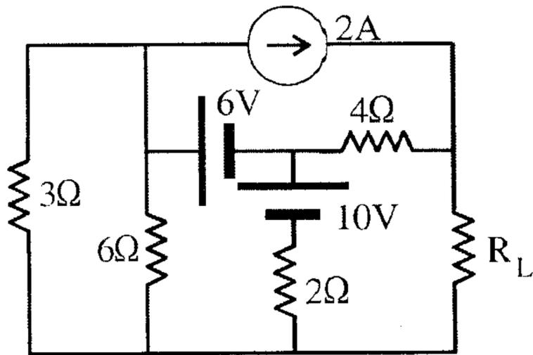
(3) أوجد أقصى قدرة منقولة لمقاومة الحمل  $R_L$  مستخدماً مكافئ نورتن عن طريق التراكيب .
