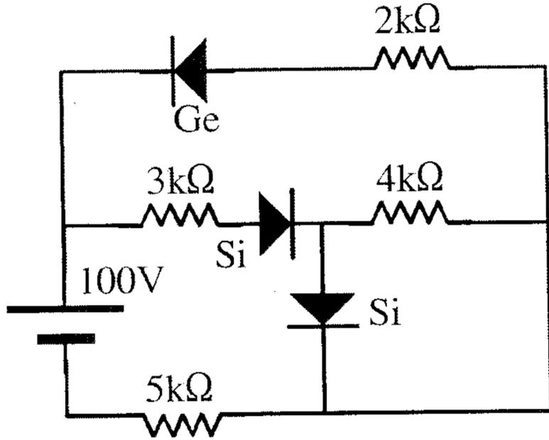
(5) للدائرة في الشكل التالي أوجد كلاً من:  $V_o$ ,  $V_{D2}$ ,  $I_{D2}$ ,  $I_{D1}$ ,  $I_R$ .
