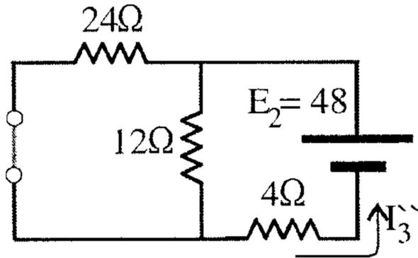
عند تأثير المصدر (  $E_2 = 48V$  ) نحذف المصدر الآخر (  $E_1 = 54V$  ) من الدائرة. نلاحظ أن اتجاه التيار  $I_3''$  عكس اتجاه التيار  $I_3'$  في الدائرة السابقة
