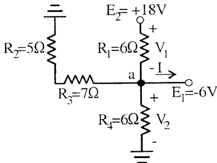
من الدائرة بالشكل التالي أوجد:  $I, V_2, V_1$
