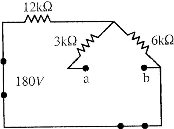
$$R_{Th} = 12k\Omega // 6k\Omega + 3k\Omega$$
