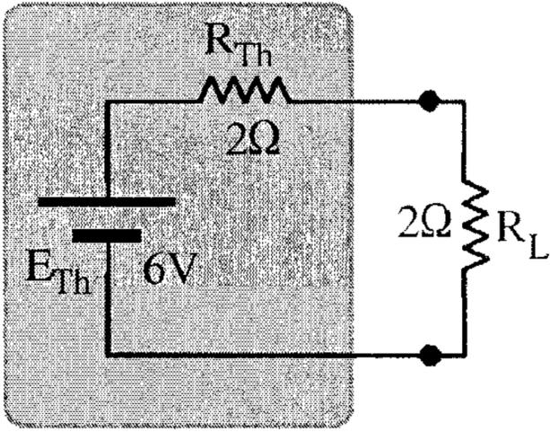
ولإيجاد التيار المار في المقاومة  $R_L$
