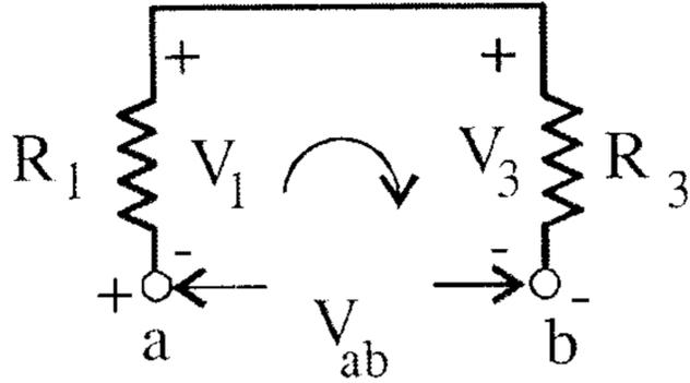
$$V_{ab} = V_3 - V_1$$
