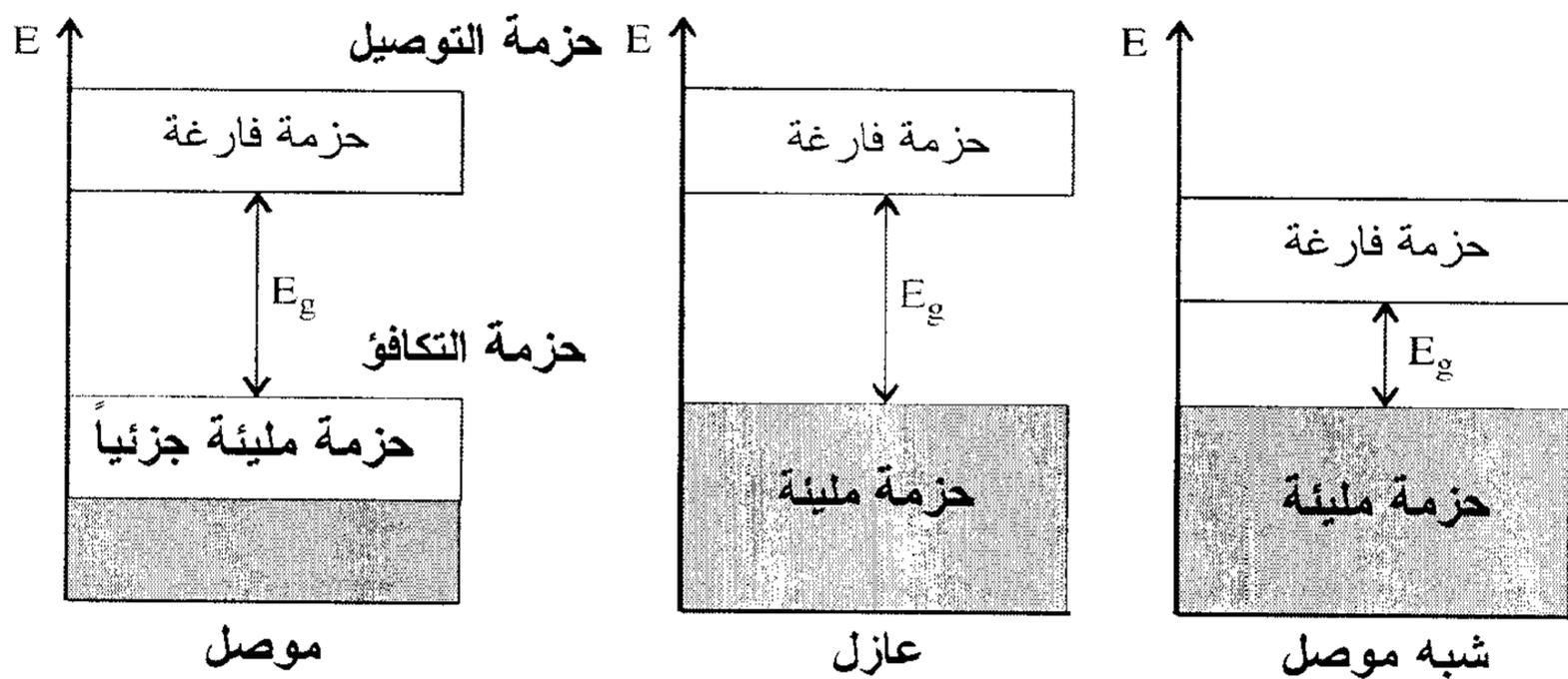
**المواد الموصلة :** هي المواد التي لها القدرة على إيصال التيار الكهربائي مثل النحاس والألمنيوم والفضة.
