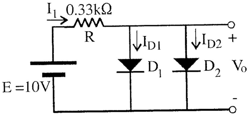
من الدائرة بالشكل التالي أوجد:  $I_{D2}$  ,  $I_{D1}$  ,  $I_1$  ,  $V_0$
