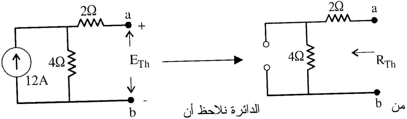
المقاومة (  $2\Omega$  ) موجودة في دائرة مفتوحة لذلك فإن التيار المار بها يساوي صفراً أيضاً
