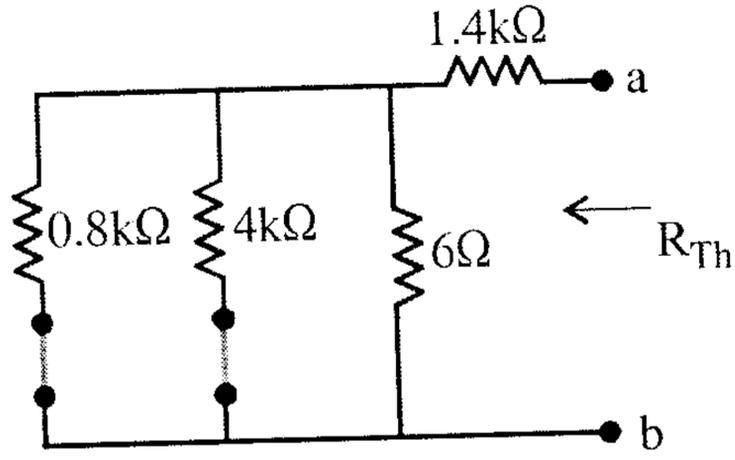
$$R_{Th} = 0.6k\Omega + 1.4k\Omega = 2k\Omega$$
