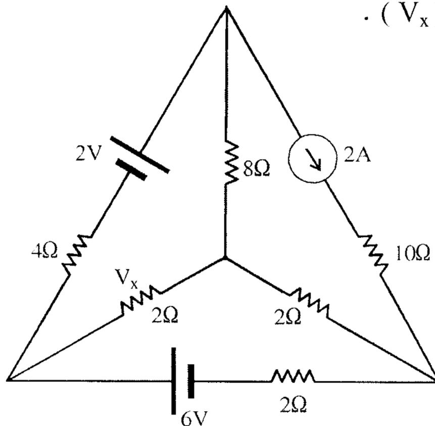
(4) باستخدام التحليل الحلقي احسب قيمة التيار ( $I_x$ ) .
