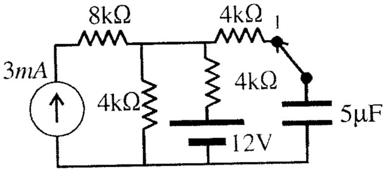
$$R_{Th} = 4k\Omega // 4k\Omega + 4k\Omega$$
