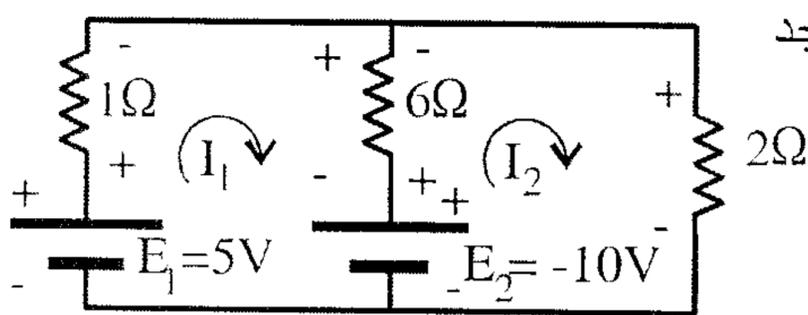
مثال 2.5: باستخدام طريقة التحليل الحلقي أوجد تيار كل حلقة في الدائرة بالشكل.
