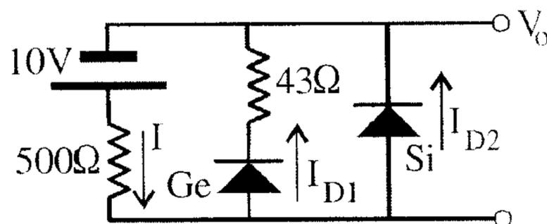
(4) للدائرة في الشكل التالي أوجد التيار المار في كل ثنائي وكذلك فرق الجهد بين طرفي كل مقاومة.
