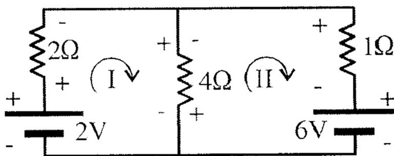
2- نحدد أقطاب كل مقاومة لكل حلقة على حدة بناءً على اتجاه التيار (الافتراضي)، حيث من المعروف أن التيار يدخل على المقاومة بالموجب ويخرج منها بالسالب. أما مصادر الجهد فأقطابها تبقى كما هي ولا يجوز تغييرها.
