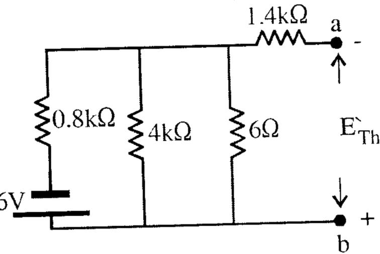
المقاومة ( $1.4k\Omega$ ) تلغى لأنها دائرة مفتوحة ومنها  $E_{Th} = V_{6k\Omega}$  بالتوازي وبالتالي تساوي  $V_{4k\Omega}$  بالتوازي أيضاً
