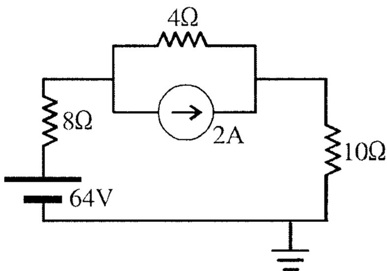
مثال 12.5 استخدم طريقة التحليل العقدي لتحليل الدائرة بالشكل التالي:
