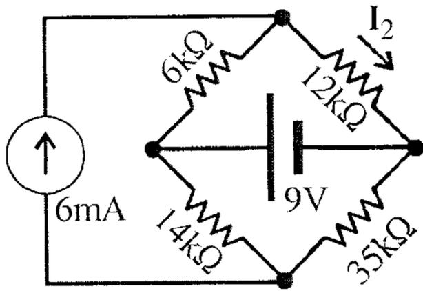
مثال 4.6 باستخدام نظرية التراكيب أوجد التيار المار في المقاومة ( 12kΩ ) .
