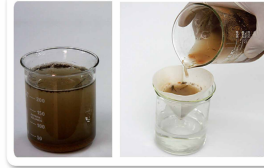
الشكل 2-1 يمكن فصل المخلوط المعلق إذا ترك دون تحريك فترة من الزمن أو فصله بالتزويق.
