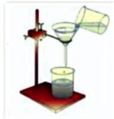
Fig. 38 filtration du mélange pour séparer le sable.
