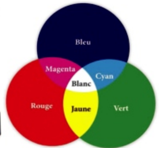
Fig.16: les couleurs jaune, cyan(bleu ciel) et magenta sont appelées couleurs secondaires. Ces couleurs sont formées par l'addition de 2 couleurs primaires.
