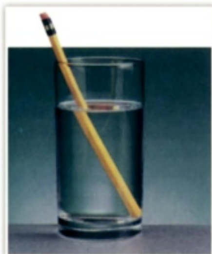
Fig.9 On peut observer clairement la réfraction de la lumière, quand on pose un crayon dans un verre rempli d'eau.
