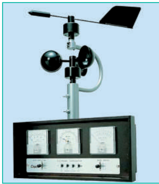
جهاز الأنيمومتر ودوارة الرياح
