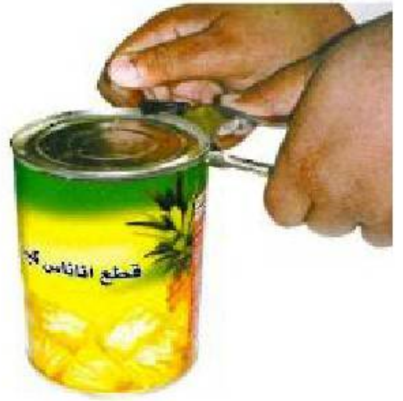
الشكل ١٥ مفتاح العلب يحول القوة الصغيرة من يدك إلى قوة كبيرة على النصل الذي يقطع غطاء العلبة.
