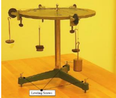
صورة توضح طاولة القوى بعد إضافة المتجهات حيث عُبر عنها بمجموعة من الأثقال ذات كتل معينة
