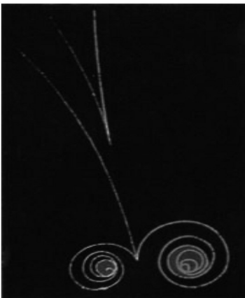
■ الشكل 18 - 11 عندما ينتج الجسيم فإن ضديده هذا الجسيم ينتج أيضاً. هنا تضمحل أشعة جاما إلى زوج من الإلكترون والبوزترون.
