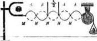
1. أصل الرنانة بواسطة أسلاك التوصيل هربطي وحدة التقذفية الموصولة بهأخذ تيار المدرسة (تيار المدينة)، وأغلق مفتاح تشغيل وحدة التقذفية لتعمل الرنانة، ماذا تلاحظ؟
