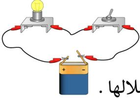
الدائرة الكهربائية - أسلاك التوصيل - المصباح الكهربائي - المفتاح الكهربائي
