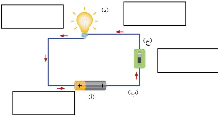
مم تتكون الدائرة الكهربائية ؟
