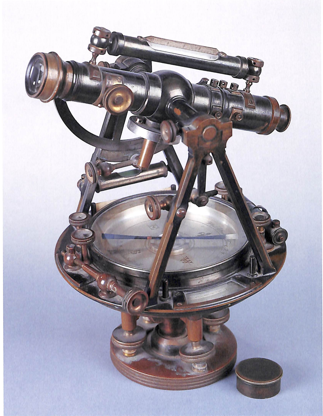
بوصلة نادرة مع جهاز قياس المسافات والاتجاهات ١٨٥٠
