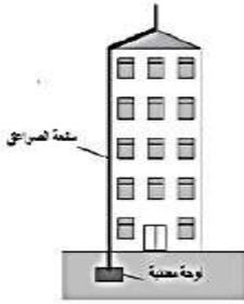
يبين الرسم التالي مانعة للصواعق مثبتة أعلى بناء شاهق وهي عبارة عن (عمود) من مادة تتصل بسلك إلى الأرض (على عمق متر تحت سطح الأرض)، وهي تعمل على تسهيل انتقال الشحنات الكهربائية الناتجة من احتكاك السحب إلى الأرض حتى تحدث عملية تفريق للشحنات الموجبة التي تتدفق إلى الأرض عبر مانعة الصواعق من غير إحداث خسائر.
