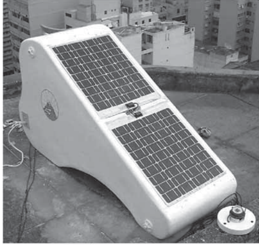
الشكل (10-26): نموذج النظام المنزلي الشمسي المتكامل في أثناء الاختبارات في كوباكابانا، ريو دي جانييرو. تصميم معتل من "مدرسة الفنون الجميلة" بجامعة UFRJ، ريو دي جانييرو.
