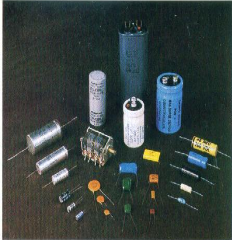
تصنع المكثفات بمختلف الأحجام لأداء عدد كبير من الوظائف فى الدوائر الكهربائية .
