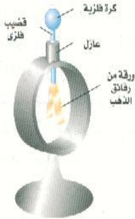
شكل 4-16: أحد نماذج إلكتروسكوب ذى وريقتين ذهبية ، ويتم عزل الجزء المكون من الكرة الفلزية ( المعدنية ) والقضيب والورقة الذهبية عن جسم الإلكتروسكوب .
