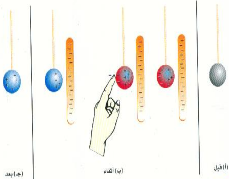
شكل 6-16: شحن كرة معدنية بالحث لاحظ أن القضيب والكرة لا يتلامسان مطلقاً ، ولكن الإصبع والكرة يتلامسان ونتيجة لهذه العملية ينتهي الأمر بالقضيب والكرة وعلى كل منهما شحنة مختلفة .
