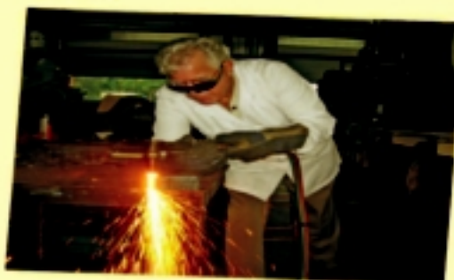
Fig. (3-14) : Le dioxygène mélangé avec l'acétylène est utilisé pour souder les métaux.
