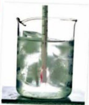
Fig. (2-11) : Le thermomètre centigrade est utilisé pour mesurer le degré de température de l'eau.
