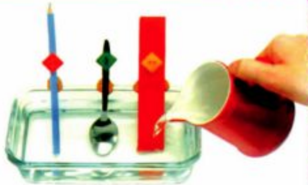
Fig. (2-2) : Les différentes matières sont différentes en leur conduction de la chaleur.
