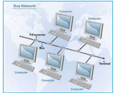
الشكل 4-27: طوبولوجيا الشبكة الخطية (Bus Topology)
