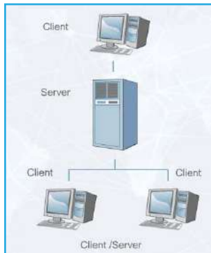
الشكل 4-31: شبكات العميل / الخادم (Client/Server Networks)
