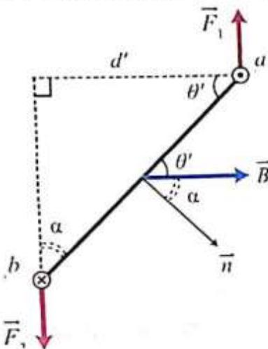
عند إمرار التيار الكهربائي في إطار المقياس، فإن الحقل المغناطيسي يؤثر في الإطار بمزدوجة كهرطيسية تعطى
