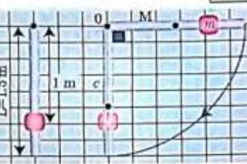
$$T_0 = 2\pi \sqrt{\frac{I_A}{(m' + M) g d}} \quad \dots\dots (1)$$
