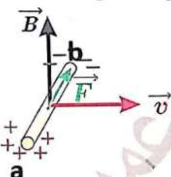
عند تحريك الساق بسرعة ثابتة  $v$  ضمن حقل مغناطيسي منتظم  $B$  بحيث:  $v \perp B$  فإن الإلكترونات الحرة في الساق ومع خصوصيتها لهذا الحقل تتأثر بقوة لورنزي:
