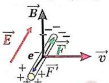
إن تراكم الشحنات الكهربائية على طرف الساق يولد حفلاً كهربائياً داخلياً  $\vec{F}$  يتجه من الطرف الذي يحمل شحنات كهربائية موجبة إلى الطرف الذي يحمل شحنات كهربائية سالبة يؤثر هذا الحقل الكهربائي في الإلكترون الحر بقوة كهربائية  $\vec{F}$  جهتها تعاكس جهة القوة المغناطيسية  $\vec{F}$  (قوة لورنتز) المؤثرة في هذا الإلكترون تزداد شدة الحقل الكهربائي بازدياد تراكم الشحنات الكهربائية مما يزيد من شدة هذه القوة الكهربائية لتصبح متساوية لشدة القوة المغناطيسية (قوة لورنتز) فتوقف حركة انتقال الإلكترونات.
