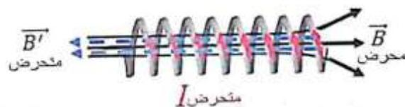
بما أن الحقل المغناطيسي  $\vec{B}$  المحرض يتزايد، فإن التدفق المغناطيسي المحرض  $\Phi$  يتزايد، وحسب قانون لenz فإن جهة الحقل المغناطيسي  $\vec{B}'$  المترعرع بعكس جهة الحقل المغناطيسي  $\vec{B}$  المحرض ليعاكس تزايد التدفق المغناطيسي المحرض.
