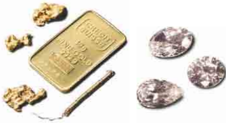
الذهب اللانفازية: غير شفاف اللون: مائل إلى الأصفر الطور عند 25°س: صلب الكثافة: 19.3 جم/مللتر الماس اللانفازية: شفاف اللون: بلا لون الطور عند 25°س: صلب الكثافة: 3.5 جم/مللتر
