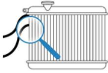
الراديتور: جزء مهم من نظام تبريد المحرك في السيارة، حيث يعمل على تبريد المياه التي تسير داخل المحرك، حيث أن ارتفاع درجة حرارة المحرك تشكل خطراً عليه وتؤدي إلى تلف العناصر الداخلية له.
