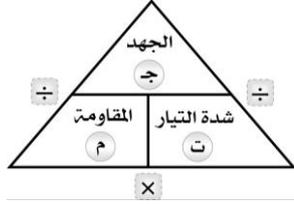
الجهد الكهربائي = التيار × المقاومة
