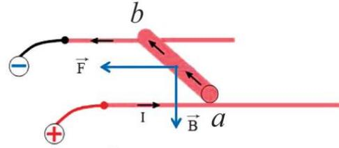
3- احسب عمل القوة الكهرطيسية المؤثرة في الساق إذا انتقلت موازية لنفسها بسرعة ثابتة قدرها  $0.5 \text{ m. s}^{-1}$  لمدة ثانيتين
