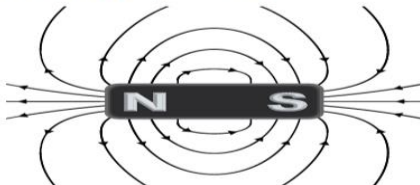
تساعد برادة الحديد على إظهار خطوط المجال المغناطيسي حول قضيب مغناطيسي.
